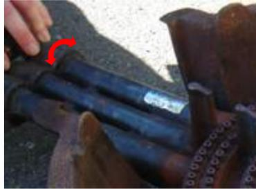
5 空気の調節は空気調節器を左右に回して行ないます。
