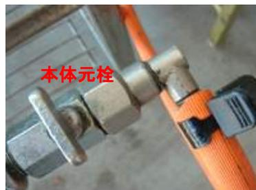
3 台付鉄板焼器本体の元栓が『閉』の位置になっている事を確認して、ガスホースを取付け、止め具で固定します。
