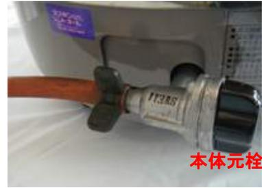
3 ガスホースを取付け、止め具で固定します。
