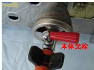
2 おでん鍋本体の元栓が『閉』の位置になっている事を確認して、ガスホースを取付け、止め具で固定します。
