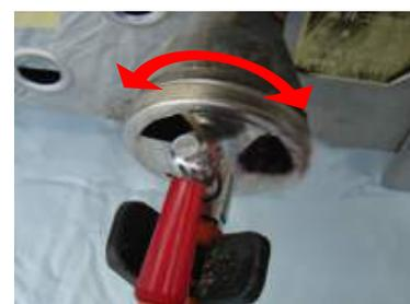
6 空気の調節は空気調節器を左右に回して行ないます。※コックは全開にしてご使用ください。
