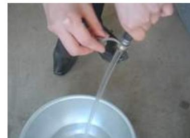
9 使用後は、電源ブレーカーをOFFにして、排水口から水を抜きます。
