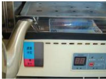
2 排水ホースのネジが締まっているのを確認の上、給水口のフタを開け、給水タンクに水を注ぎます。(約6L)
